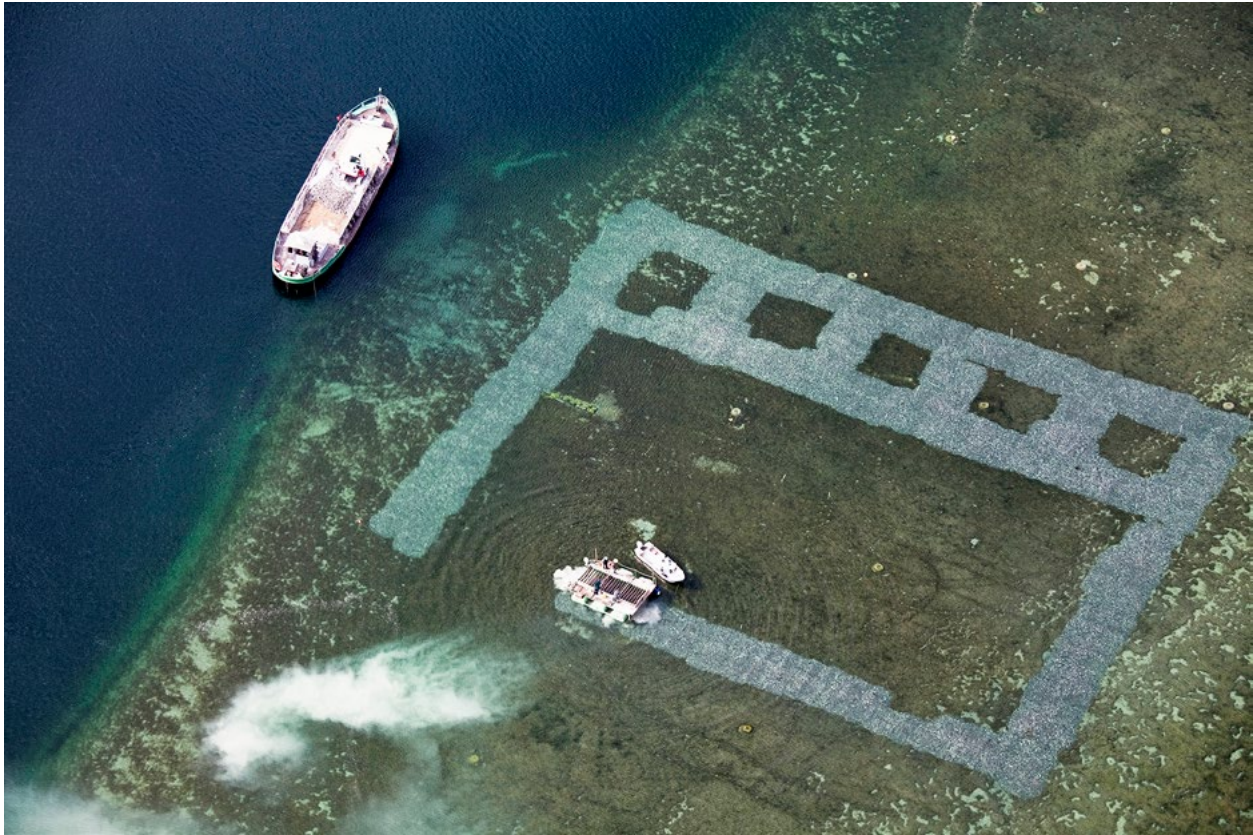
Figure 4. Protective cover. Aerial view of the lattice-structured gravel covering in Sipplingen Bay. Baden-Württemberg, Lake Constance (Landesamt für Denkmalpflege im Regierungspräsidium Stuttgart, Hemmenhofen, O. Braasch).
